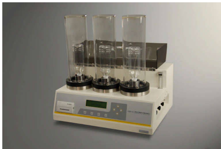
图 1. PERME 系列 TOY-C1 等压法薄膜/容器透氧仪
