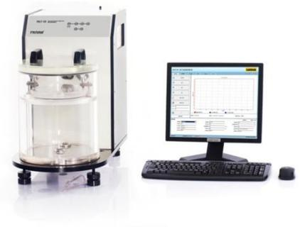
RGT-01 采用了压差法测试原理与液位分析技术相结合的测试方法；试验中，首先将真空室内腔注满水，盖上密封板，然后在计量筒内缓慢的注水至指定的区域，盖好上盖，压紧密封板，同时对试验腔进行抽真空至试样膨胀，最后通过液位分析及相关计算，得出包装袋内残余的气体量。
