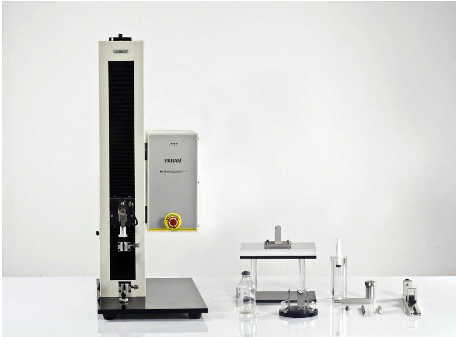
Labthink兰光最新推出的这款MED-01医药包装性能测试仪是特别按照YBB00042005《注射液用卤化丁基橡胶塞》、GB 15811-2001《一次性使用无菌注射针》、GB 2637-1995《安瓿》、GB 14232.1-2004《人体血液及血液成分袋式塑料容器 第1部分传统型血袋》、YY 0613-2007《一次性使用离心袋式血液成分分离器》、YBB00112004《预灌封注射器组合件（带注射针）》、GB 15810-2001《一次性使用无菌注射器》等标准进行瓶用胶塞穿刺力、注射针针尖穿刺力、安瓿折断力、软塑料容器外加压密封性、针管与针座连接力、针头护帽拔出力、活塞滑动性能以及器身密合性等项目的检测。同时该设备也可以通过配置其他测试附件，实现其他包装材料、医疗器械等样品的检测。
